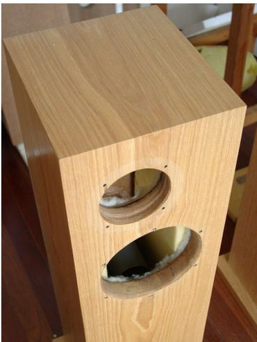
Vista del interior, con la gomaespuma de la pared lateral, la pared trasera desnuda y la pared delantera con una capa de guata.
